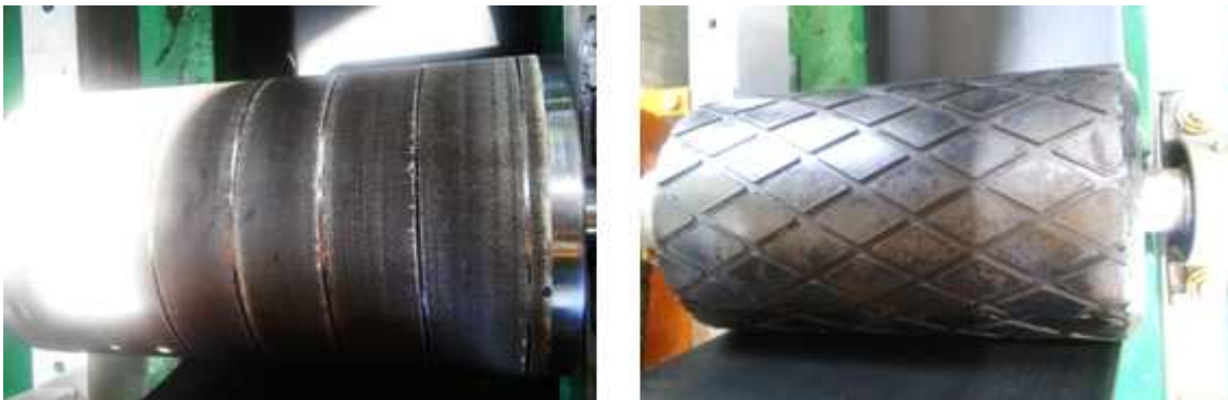
그림 1] 컨베이어 벨트 시스템에 사용된 개발 pulley(좌) 및 기존 pulley(우)
