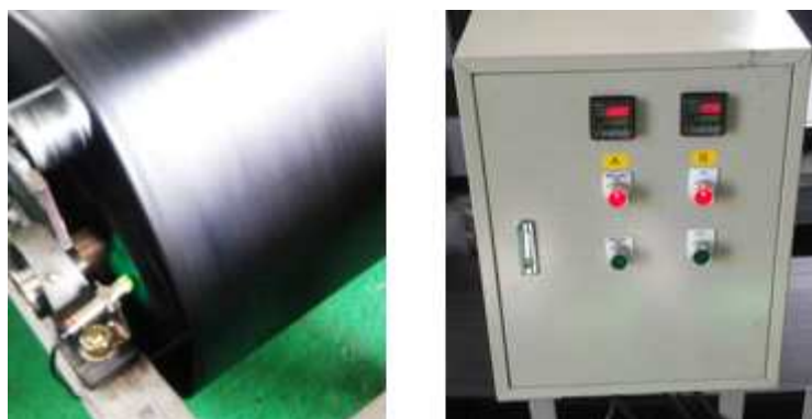
그림 2] 회전 수 측정에 사용된 센서(좌) 및 계기판(우)
